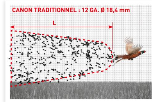
Avec un canon traditionnel (Ø 18,4 mm) les frictions entre la charge et les parois du canon sont importantes. Ces plombs ainsi déformés auront une perte de vitesse par rapport aux plombs se trouvant au centre de la charge. En conséquence, avec une large différence de vitesse entre l'ensemble des plombs contenus dans la cartouche, la gerbe sera très étirée et générera des difficultés à avoir un tir efficace et précis.
