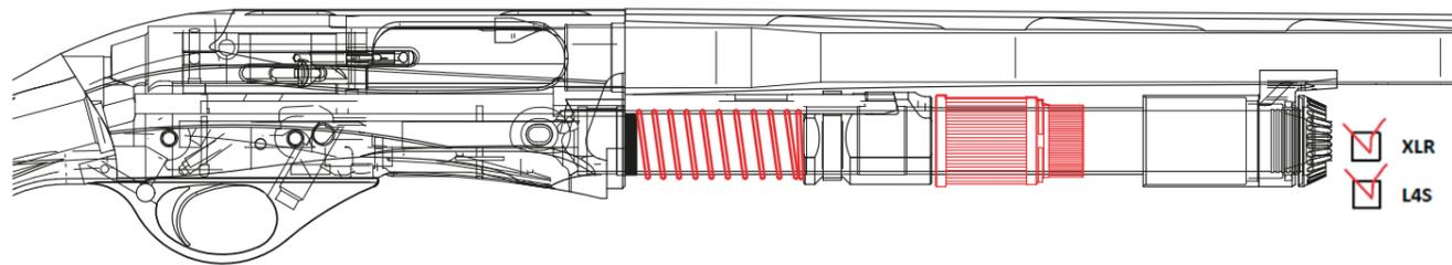
Le ressort de rappel servant au réarmement de l'arme est placé sur le tube magasin, en position parfaitement parallèle à l'axe du canon. Cette configuration génère une stabilité en tir sans commune mesure avec les armes qui ont ce ressort de rappel dans la crosse, configuration où axe du ressort et axe du canon forme un angle de 15 degrés environ et entraîne un recul saccadé et instable.
