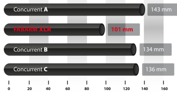
Tests en laboratoire avec cartouches Semi-Magnum 42 g. Moyenne sur 5 tirs avec chaque arme. Température 21 °C Humidité : 23 %
